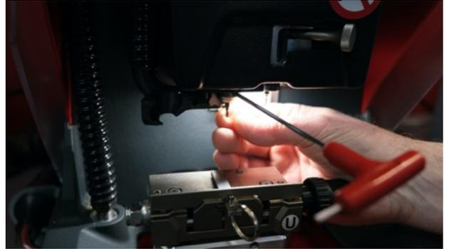
Install the **CUTTER V037**. PRESS **OK**
