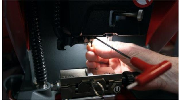
Install the **CUTTER V037**. PRESS **OK**
