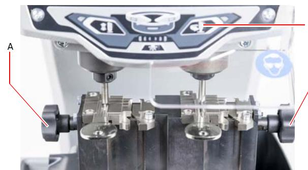
**Hinweis:** Cisa-Schlüssel, die sich nicht an der Standardspannvorrichtung links von der Spannbacke einspannen lassen, können an der rechten Spannvorrichtung an der dafür vorgesehenen Halterung befestigt werden, die ein Kippen vermeidet.
