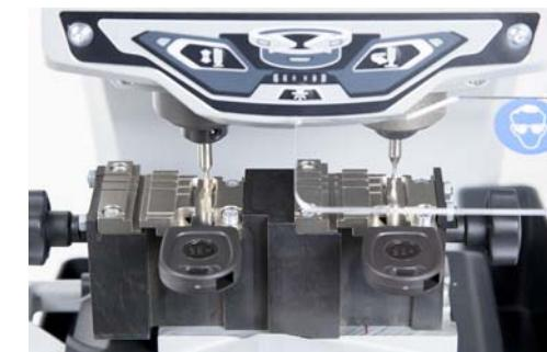
3. Den Schlüsselrohling in die rechte Spannbacke einspannen.
