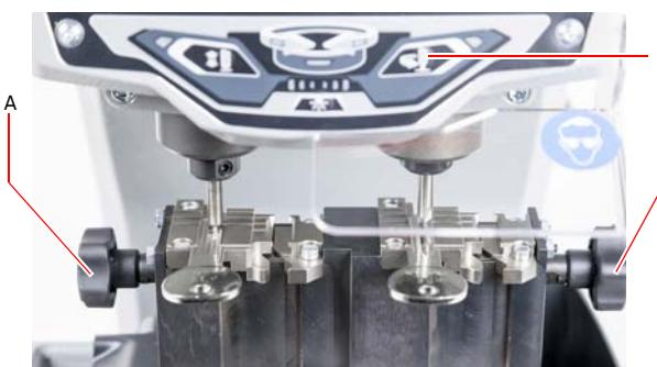
**注:** Cisaキーはクランプの左側の標準ホルダーでは固定できません。専用ホルダーを用い、右側ホルダーに固定して、キーが外れるのを防ぎます。
