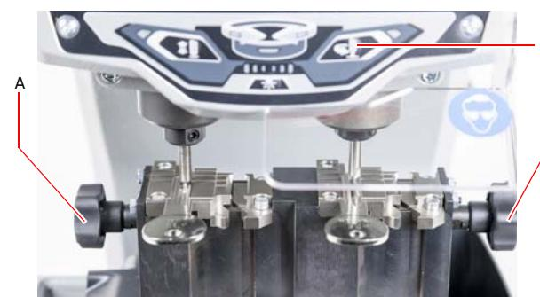
**备注 :**Cisa 钥匙不能够固定到在夹紧装置左侧的标准夹具，可以固定到右侧专门的夹具，可以防止钥匙翻斗。
