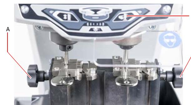
**Remarque :** Les clés Cisa qu'il est impossible de fixer à la prise standard à gauche de la mâchoire, peuvent être fixées au niveau de la prise de droite sur un dispositif de tenue dédié qui évite son basculement.
